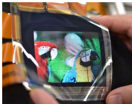
有機トランジスタを用いた フレキシブル有機ELディスプレイ
