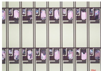
印刷電極 最小 Line/Space 5 μm/5 μm
