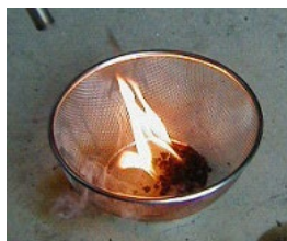
汚泥の燃料化
